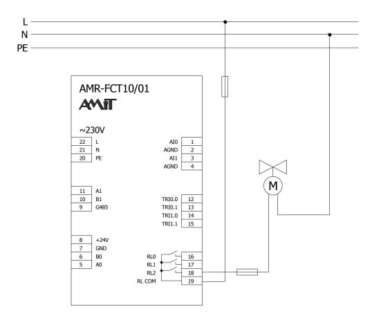
Fig. 14 – Relay output wiring example
