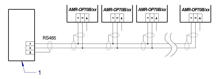
Fig. 6 - RS485 wiring
